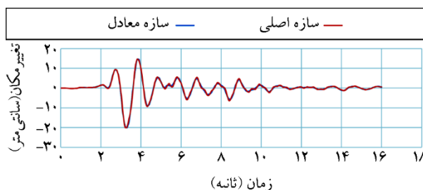
شکل (۸): منحنی تغییر مکان ارتجاعی سازه‌ی معادل و سازه اصلی برای زلزله بم با نصف شتاب ثقل.
