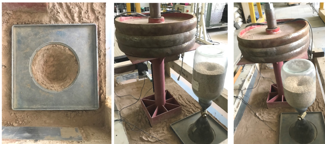
شکل (۶): آزمایش دانسیته در محل برای اندازه‌گیری درصد تراکم خاک.
