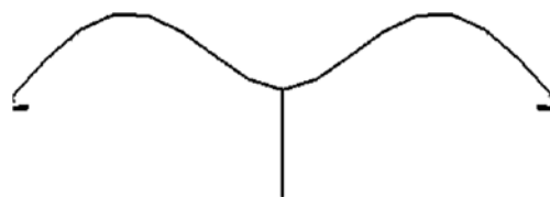
شکل (22): مد ششم (مد قائم) با استفاده از نرم افزار OpenSees
