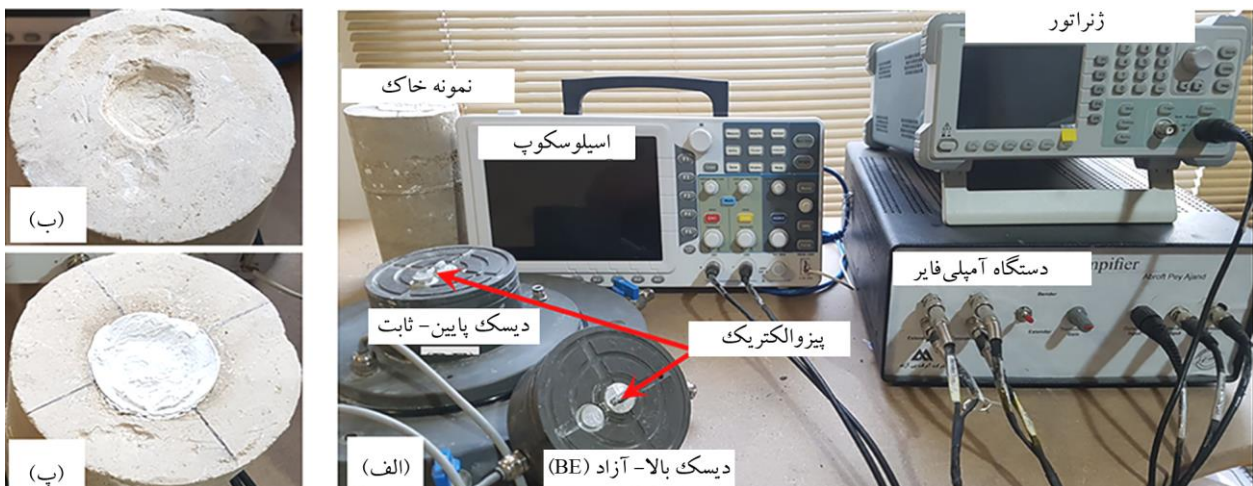
شکل (۳): (الف) سیستم‌های مرتبط با آزمایش المان خمشی، (ب) نمونه شیار خورده و (پ) نمونه آماده آزمایش.
